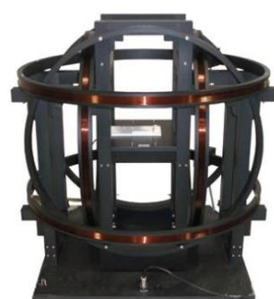
Assemblage 3D Helmholtz pour l'étalonnage de mesure 3 axes
