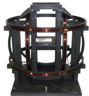
Assemblage 3D Helmholtz pour l'étalonnage de mesure 3 axes
