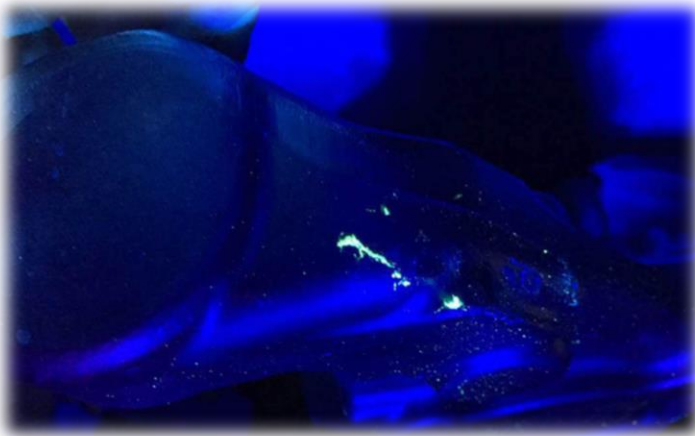
Cliché obtenu en contrôle par Ressuage
