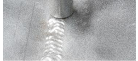
Mesure du taux de ferrite et de l'évolution de \mu_r sur cordon de soudure
